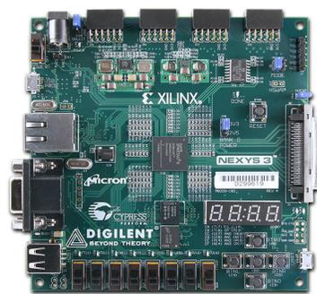
**Figura 5: La tarjeta de prototipado Nexys 3 equipada con un FPGA Spartan-6 de la compañía Xilinx.**
