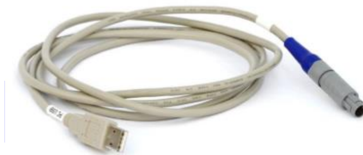
Figura 7. Cable USB entre g.Hlamp y PC.
