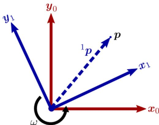
donde el vector de posición  ${}^1p$  es fijo con respecto al sistema  $o_1x_1y_1$  y a su vez este sistema está girando con una velocidad  $\omega$  con respecto al sistema  $o_0x_0y_0$ .
