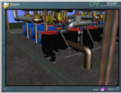
Figura 9. Bombas de trasiego en una planta generadora
