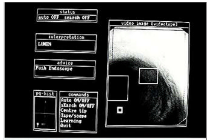
Figura 5. Sistema de visión para endoscopia. El sistema obtiene características relevantes como la zona oscura (cuadro resaltado en la imagen derecha) y con base en ello ayuda al médico a guiar el endoscopio (ventanas con la interpretación y consejos a la izquierda) hacia el centro del tubo digestivo, lo que se conoce como el lumen.
