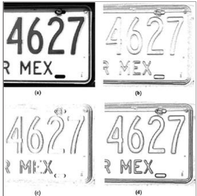
Figura 3. Proceso de detección de bordes en una imagen: a) imagen original, parte de una placa de automóvil; b) detección de bordes horizontales; c) detección de bordes verticales; d) bordes totales, obtenidos al combinar los horizontales y los verticales.
