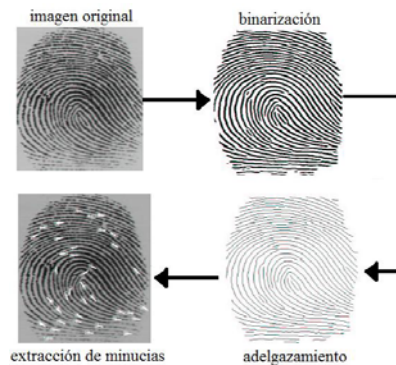
Figura 5. Proceso de extracción de minucias
