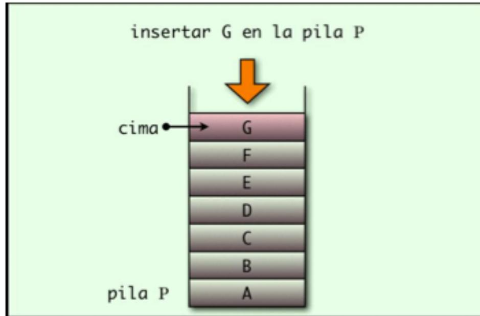
Existe solamente un lugar en donde cualquier elemento puede ser agregado a la pila. Después de haber insertado el nuevo elemento, G ahora es el elemento en la cima.
