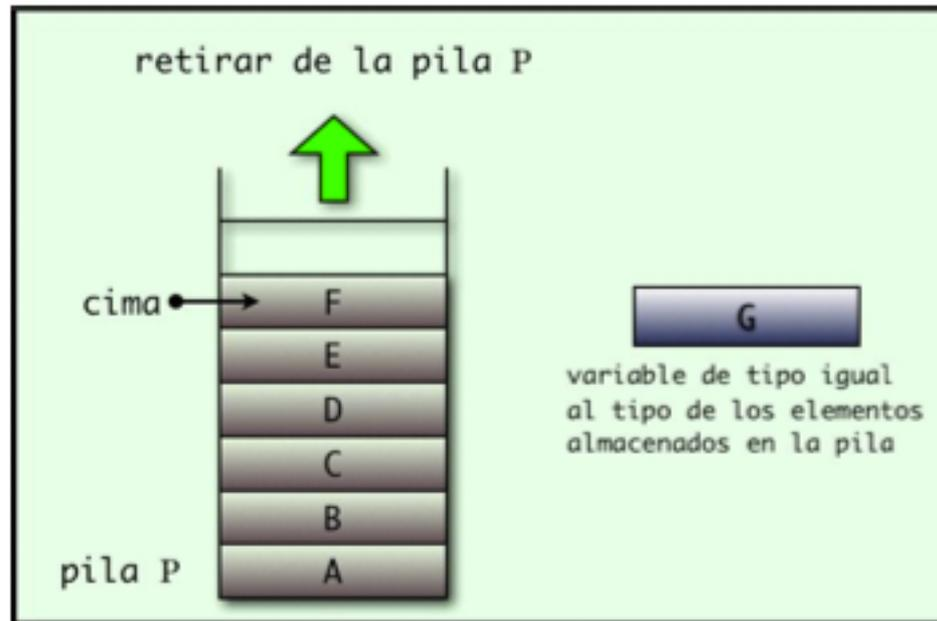
Basta indicar que sea retirado un elemento. No podemos decir “retirar C”, porque C no está en la cima de la pila.
